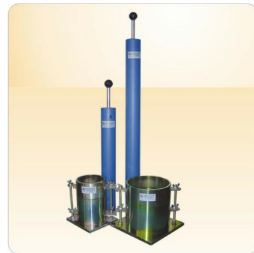
Fig: Proctor Compaction Apparatus
